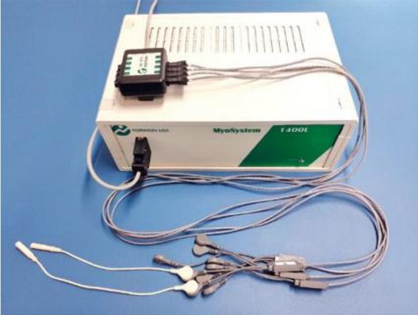
**Figura 6.** Electromiógrafo MyoSystem 1400L de ocho canales usado en el proyecto (Noraxon, Scottsdale, Arizona, EE. UU.); (fotografía: material propiedad del autor).
